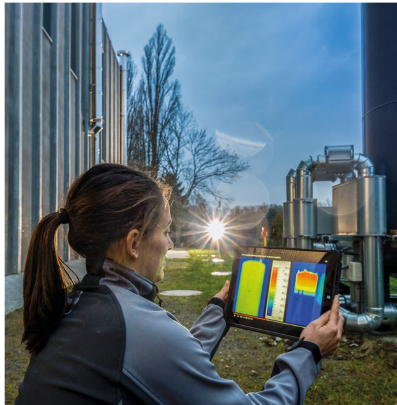
Thermographie von Klimatechnischen Komponenten an der ETA-Fabrik
