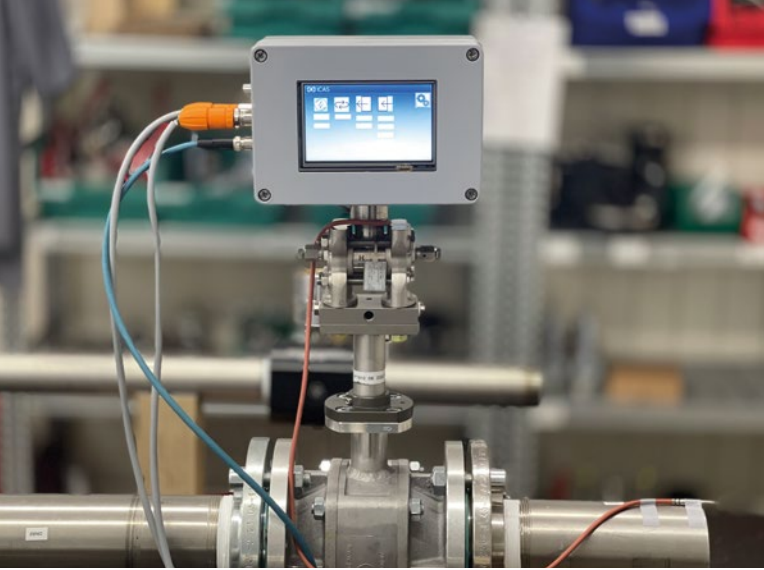
Staudrucksonde mit System on Chip(SoC)-basierter Elektronik für maschinelles Lernen
