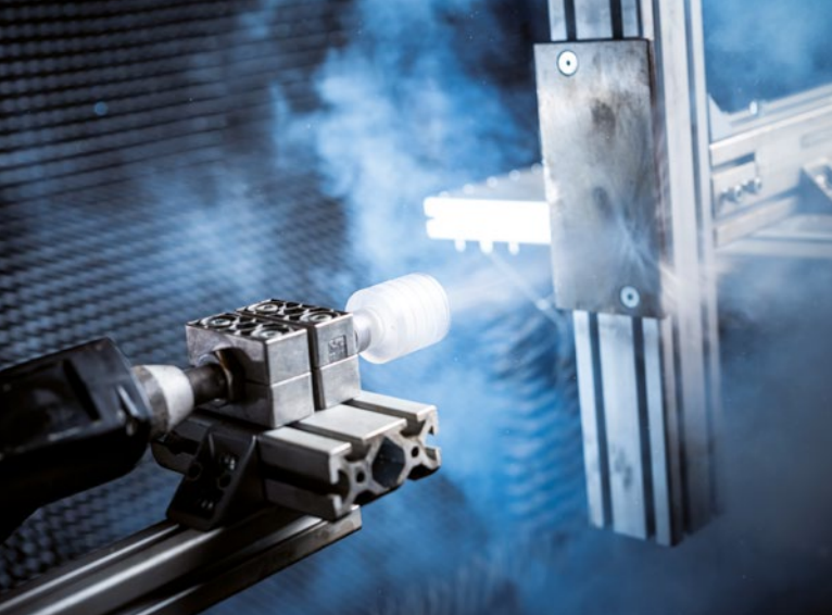
Trockeneisstrahlversuch mit aufgeschraubtem Schalldämpfer zur Schallpegelmessung
